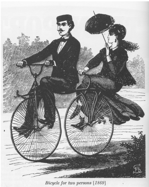
図 27 2人乗り2輪型自転車(1869) --- 直結回転ペダル型
